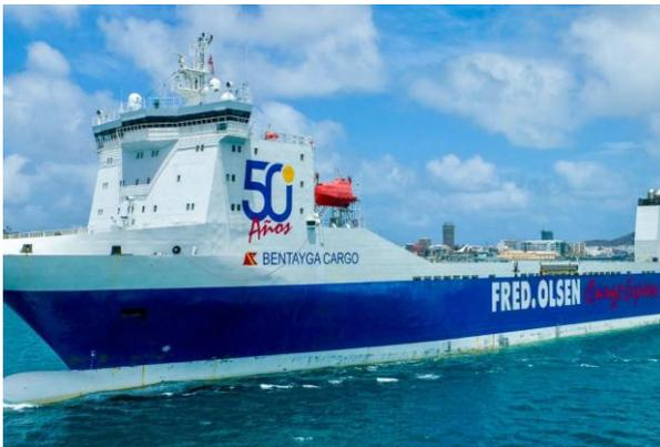
Este buque de tipo RORO tiene una capacidad de carga de 1800 metros lineales y 9000 toneladas. Cuenta con más de 160 metros de eslora, 2 hélices transversales para la maniobra y una velocidad máxima de 20 nudos.
